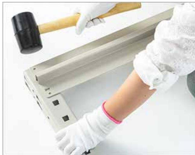
●拡大図2：最下段もハンマーで叩き込みます
