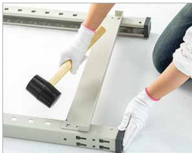
●拡大図2：最下段もハンマーで叩き込みます
