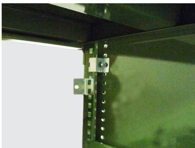
支柱穴に背パネル用の金具を取り付けます。
