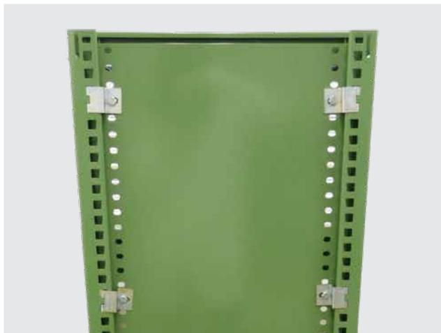
側パネルを全ての金具に取り付けたら本締めします。
