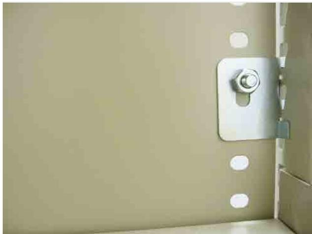
背パネルを上下の金具に位置を合わせボルトナットで仮締めします。
