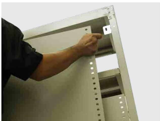
背パネルが2枚以上ある場合は、まず下側のパネルを仮締めした後に上側のパネルを下側のパネルと重ね合わせてボルトナットで一緒に仮締めします。
